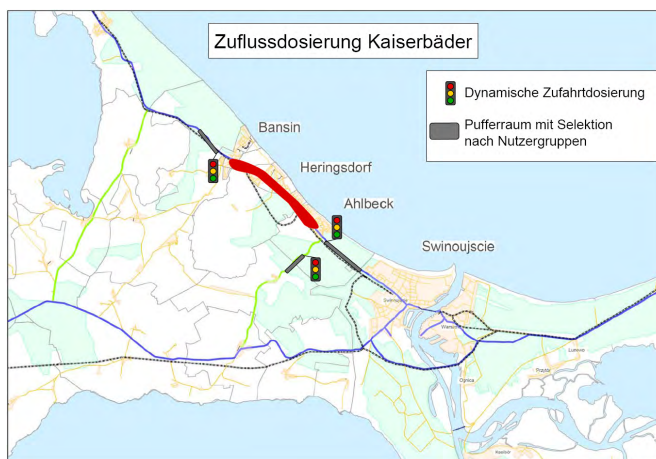
Abb.9: Beispiel Zuflussdosierung in den Kaiserbädern
